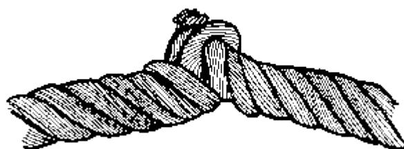
Рис. 15. Перекручивание каната
