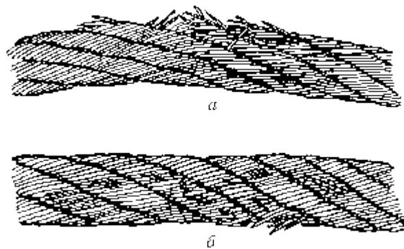
Рис. 3. Обрывы проволок в зоне уравнительного блока:
