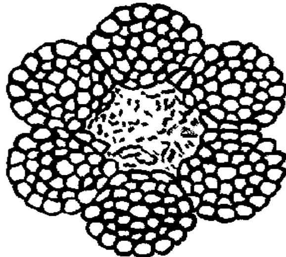
Рис. 8. Уменьшение площади поперечного сечения проволок (интенсивная внутренняя коррозия)
