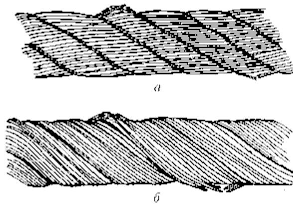
Рис. 2. Сочетание обрывов проволок с их износом:
